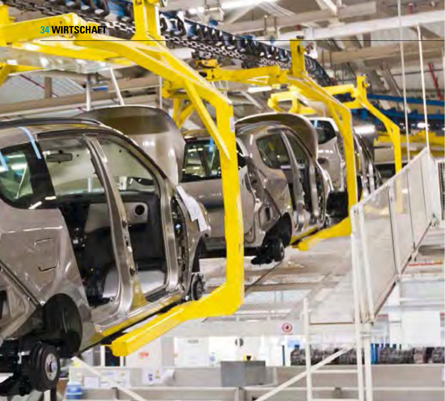
Karosserien in der Automobilindustrie werden durch eine Elektrohängebahn von Phoenix Contact aus Blomberg im Kreis Lippe in den nächsten Bearbeitungsabschnitt transportiert.
